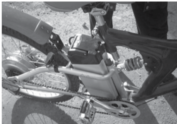
Den elektriske motoren er plassert i baknavet. I forgrunnen sees batteriet. Det lades opp etter ca 25 kilometer. God tur!
